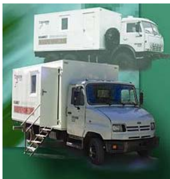
Рис.2. Цифровые флюорографические кабинеты на шасси ЗИЛ и КАМАЗ производства ЗАО «Рентгенпром» и НПО «Экран»
