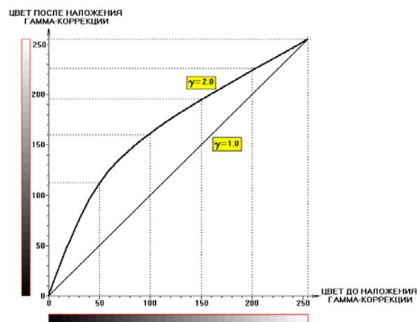
**Рис. 3** Наложение гамма-коррекции.
