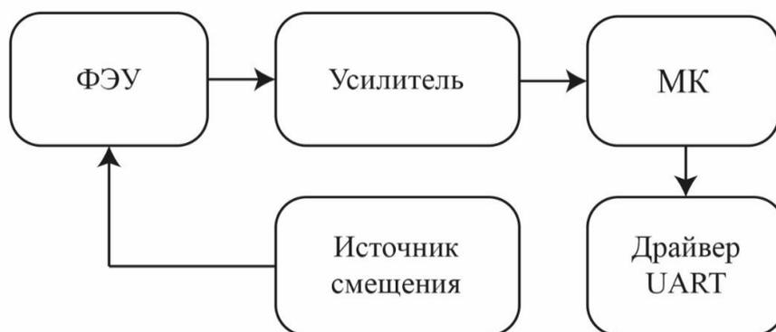
Рис. 3. Блок-схема датчика дозы рентгеновского излучения.
