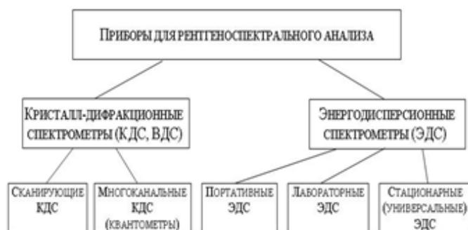
Рис. 1. Классификации рентгеноспектральных приборов.
