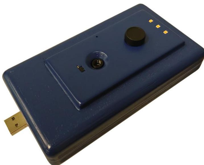
Рис. 3. Внешний вид термовизора.
